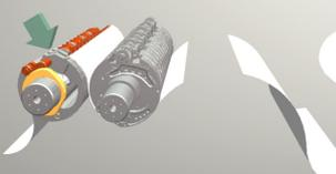
Der Bedruckstoff wird von den **Greifem** des **Gegendruckzylinders** übernommen und in die **Druckzone** zwischen Druckzylinder und Gummizylinder geführt. Der Greiferschluss erfolgt dabei automatisch durch das Abrollen auf der sogenannten **Greiferkurve**. Genauere Informationen zur Druckabwicklung erhalten Sie in Modul 2.
