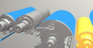
Das Greifersystem der **ersten Übergabstrommel** übernimmt den Bogen an der Vorderkante vom Druckzylinder des vorhergehenden Druckwerks. Da der Bedruckstoff hier mit der **hoch elastischen Saße** auf der Trommeloberfläche liegt, ist diese so beschaffen, dass ein **abschmierfreier Bogentransport** gewährleistet ist. Hilfsgrafik SuperBlue-Jackets
