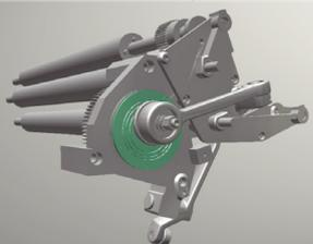
Über die Position der Kopplung kann der **Einsatzpunkt** der Verreibung eingestellt werden. Zum Beispiel an der Speedmaster sind die entsprechenden Positionen mit roten und weißen Ziffern gekennzeichnet, wobei Weiß 1 der Standardstellung entspricht. Diese wird hier auch dargestellt.
