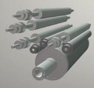
Die Farbreiber übertragen unterschiedlich viel Farbe, je nach dem ob sie sich nur drehen oder sich zugleich seitlich (axial) bewegen. Aus diesem Grund wird im Einsatzpunkt (in dem sie sich nur drehen) mehr Farbe übertragen. Unter anderem kann so Einfluss auf die Stelle, an der die **Farbanhäufung** übertragen wird, genommen werden (siehe **Grafiken**).
