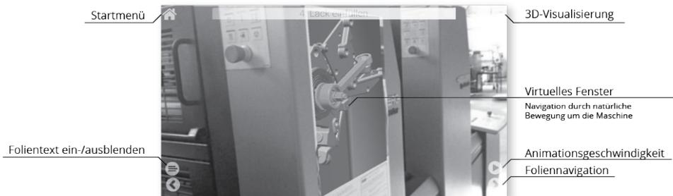
Abbildung 11: Screenshot einer augmentierten Druckmaschine
