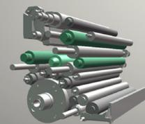
Die Farbübertragwalzen sorgen für einen gleichmäßigen Transport der Farbe zur Druckform und dienen als Farbspeicher.
